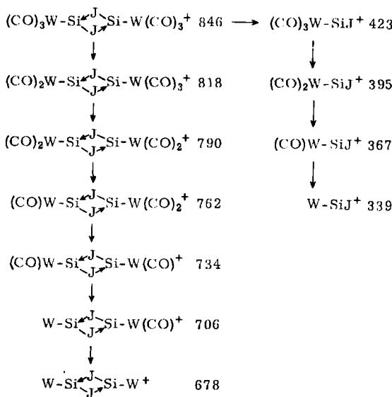
monomeren Zustand besseren koordinativen Absättigung der Si-Atome führen. Die vier signifikanten Wolframisotope  $^{182}\text{W}$ ,  $^{183}\text{W}$ ,  $^{184}\text{W}$  und  $^{186}\text{W}$  sollten bei Anwesenheit von zwei Wolframatomen zu 10 Signalen kombinieren, was im Massenspektrum auch beobachtet wird.
